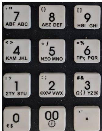
Το **αριθμητικό πληκτρολόγιο (0...9)** χρησιμοποιείται για την εισαγωγή ποσοτήτων, ποσών και αριθμών, καθώς και κειμένου σε λειτουργία προγραμματισμού. Το πλήκτρο <00> εισάγει 2 συνεχή μηδενικά ή το κενό (space) σε λειτουργία εισαγωγής κειμένου. Επίσης σε συνδυασμό με το πλήκτρο F εμφανίζει την τρέχουσα ώρα και ημερομηνία.
