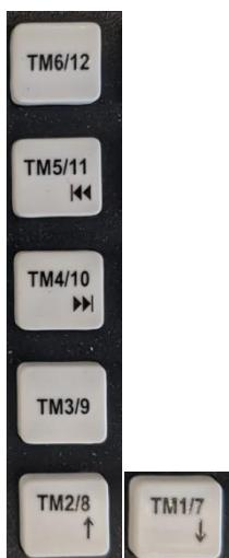
Τα **πλήκτρα των τμημάτων** χρησιμοποιούνται για τα αντίστοιχα τμήματα 1-6 και 7-12 σε συνδυασμό με το πλήκτρο <επιπέδο (F)>.
